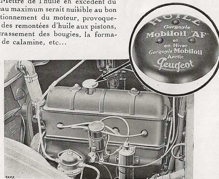
Fig. 25. — Orifice de remplissage d'huile.
